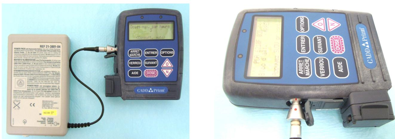
Si nécessaire, le bloc d'alimentation peut être rechargé pendant qu'il est raccordé à la pompe. Aligner la marque rouge sur le raccord de l'adaptateur AC avec la marque **rouge** de la prise du bloc d'alimentation **sans tordre ni tourner**.
