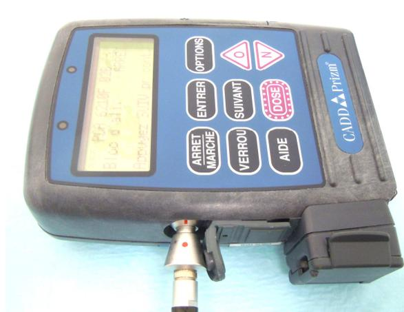
Si nécessaire, le bloc d'alimentation peut être rechargé pendant qu'il est raccordé à la pompe. Aligner la marque rouge sur le raccord de l'adaptateur AC avec la marque **rouge** de la prise du bloc d'alimentation.
