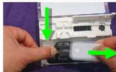
Maintenir la tubulure au fond avec la main gauche et tirer doucement sur le filtre de sorte à faire pénétrer complètement le tube au fond du capteur du détecteur d'air.
