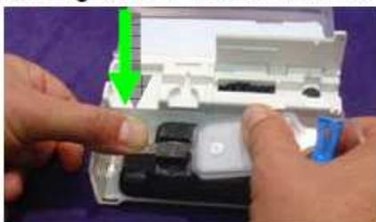
Insérer la tubulure au fond du logement dans l'axe de la fente du détecteur d'air
