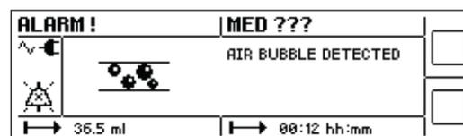
Si le nombre de bulles d'air dans la tubulure dépasse la limite pré-configurée, l'alarme "Trop de bulles d'air" se déclenche.
