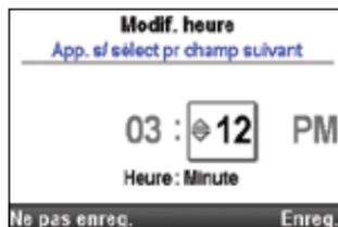
Si votre pompe a été configurée pour utiliser une horloge 24 heures, les champs **AM** et **PM** n'apparaissent pas. Sélectionnez **Enreg.**
